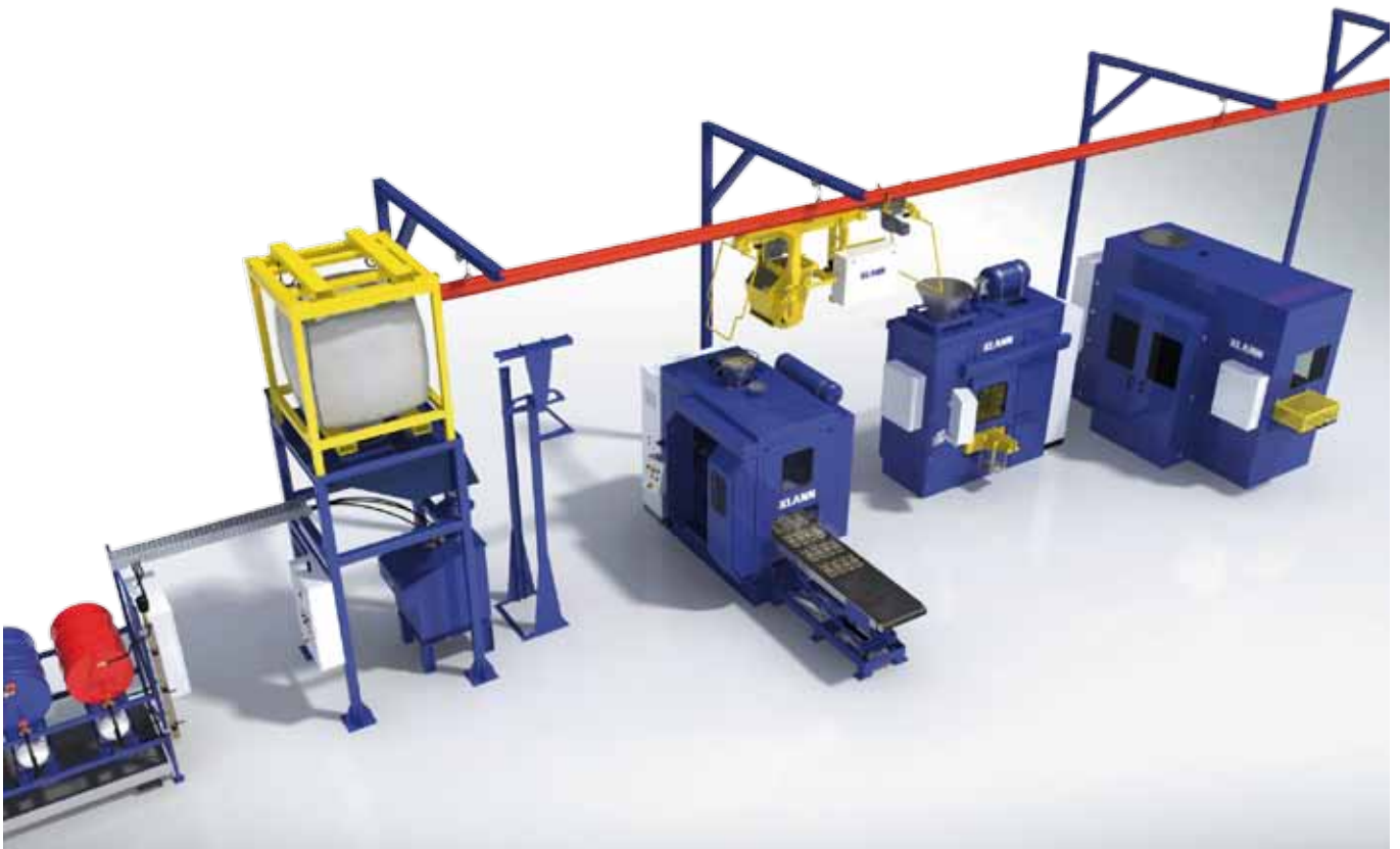
Mögliche Anlagenkonfiguration mit Kernsandtung und -verteilung
