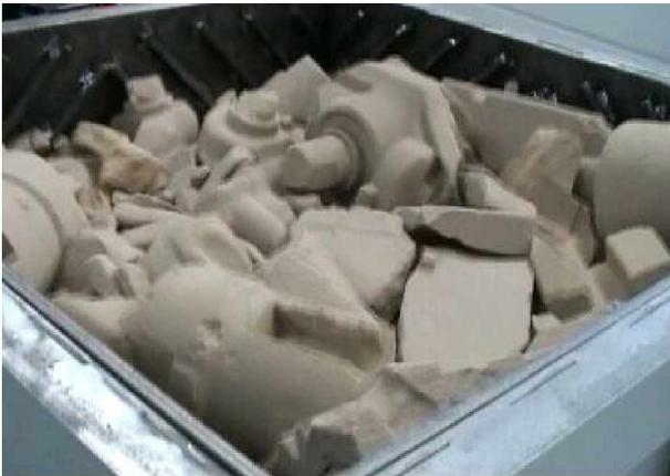
Fig1 : Auge de broyage avec débris de noyau
