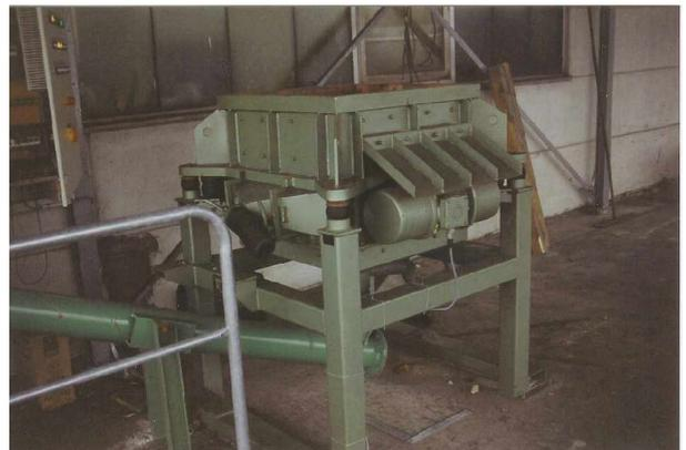
Fig 2: Auge de broyage de l'installation de recyclage de débris de noyau dans une fonderie
