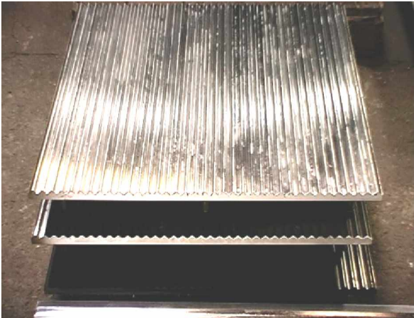
Abb. 1: profilierte Schleißbleche für Schrottpaketierpressen.
